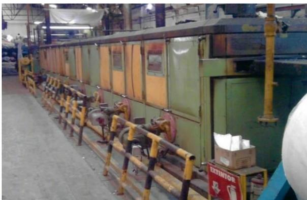
**Figura 2.11.** Rama donde la tela es planchada, cortesía de Doral Tex S.A. de C.V.
