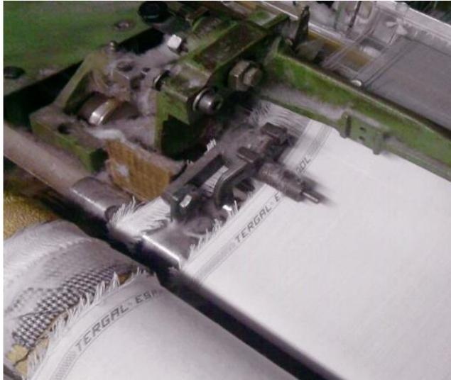
**Figura 2.3.** Fabricación del orillo a la salida del telar, cortesía de Doral Tex S.A. de C.V.
