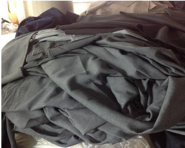
**Figura 1.4.** Desecho de tela por diferencia de tonalidad en los rollos, cortesía de Bonpros S.A. de C.V.
