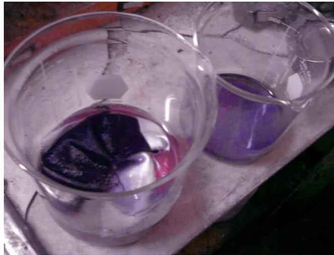
**Figura 2.7.** Prueba de deslavado en el laboratorio, cortesía de Doral Tex S.A. de C.V.
