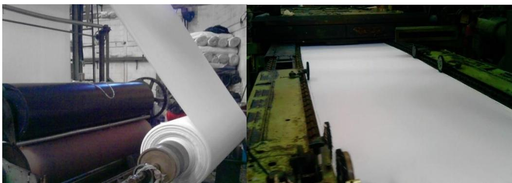
**Figura 2.10.** El lote de producción recibe el proceso de baño y cilindrado al ingresar al horno, cortesía de Doral Tex S.A. de C.V.
