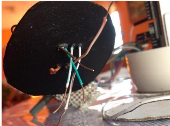
**Figura 3.7.** Cable UTP montado a la base y listo para soldar.
