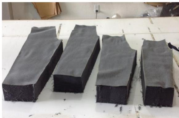
**Figura 1.1.** Diferencia de tonalidades de un mismo lote de tela fabricando pantalón, cortesía de Bonpros S.A. de C.V.
