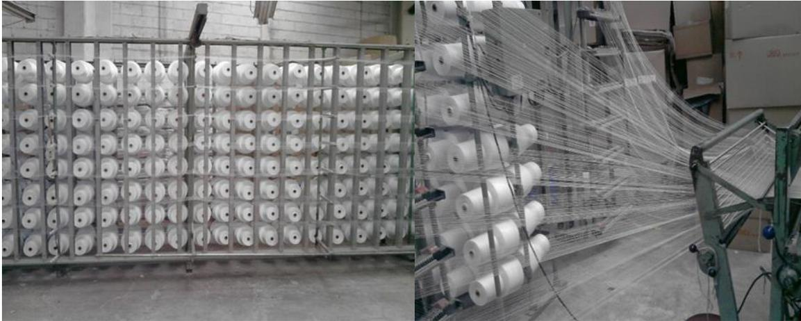
**Figura 2.1.** Proceso de acomodo de hilos para ser tejido, cortesía de Doral Tex S.A. de C.V.
